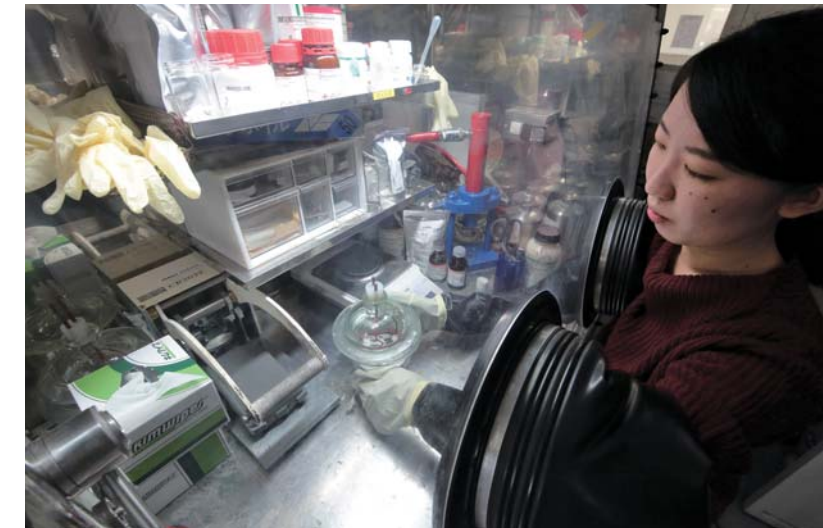
▼グローブボックスの中で全固体電池を組み立てる様子
